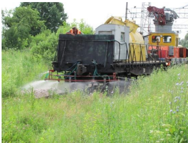
Фото 1. Опрыскивание железнодорожного пути путевым штанговым опрыскивателем ОПШ-5А
